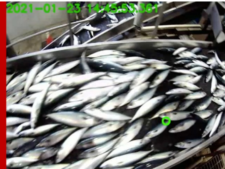
漁業1 重量選別(稼動状態)
